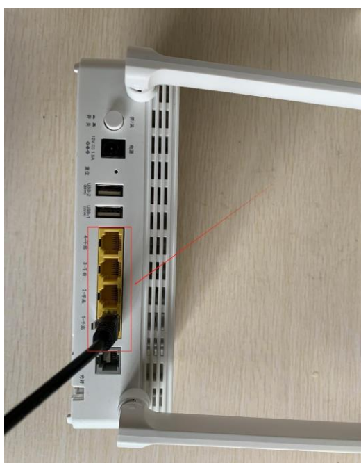
图 1-1 电脑网线连接旧校园网墙面信息端口侧拔出
